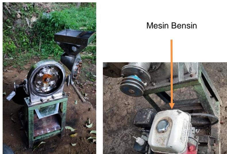
**Gambar 2.** Konstruksi mesin penggiling (hummer mill) gula kristal yang ada (existing)
