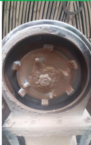
**Gambar 3.** Pelelehan gula aren semut pada proses penggilingan yang menempel pada sudu mesin.
