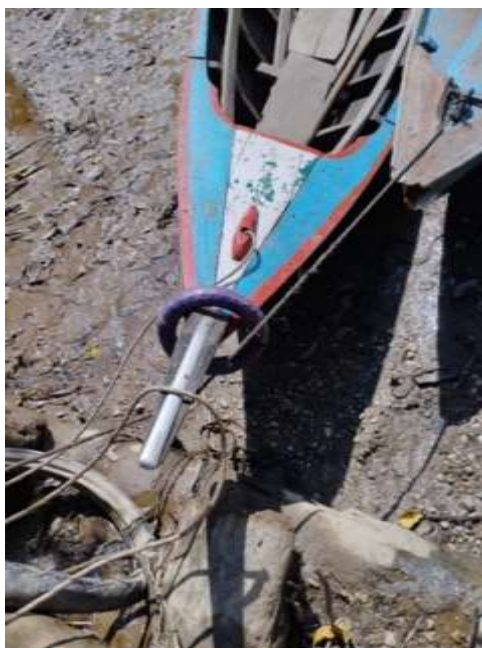
Gambar 8. Tangkong Atau Linggi Sampan Leper Berbentuk Kepala Burung. Dokumentasi: Ahmad Maulana, Pekan Arba, 26 April 2024.
